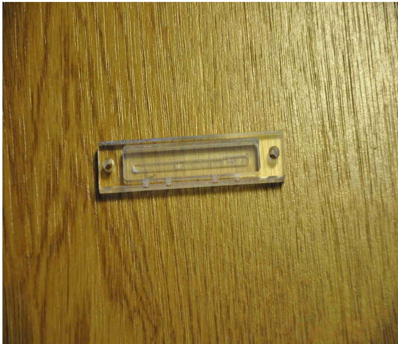
Abbildung 2: Neues Gehäuse aus Plexiglas gefräst
