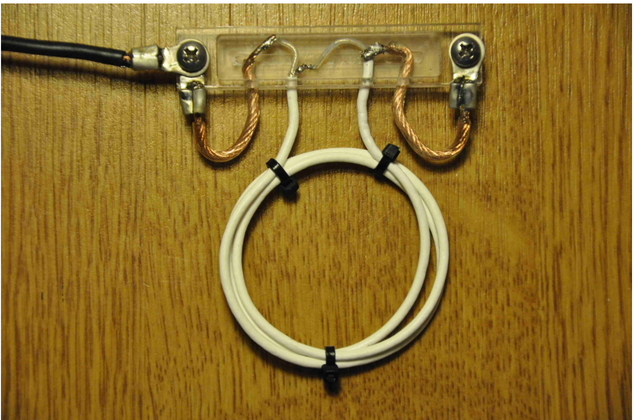
Abbildung 3: Fertig eingesetzter und verlöteter Sperrkreis
